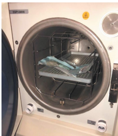
Рис. 4. Стерилизация моделей в автоклаве
