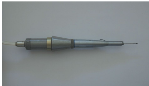
Рис. 1. Устройство турбинной пневмобормашины в сборе со стоматологическим наконечником
