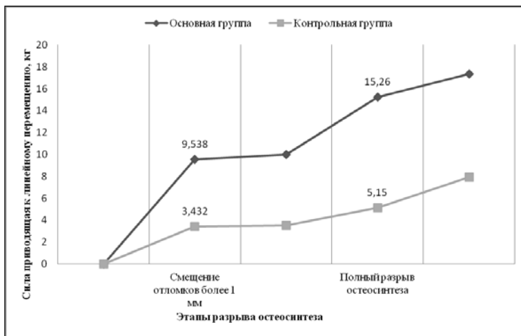
Рис. 2. Измерение силы линейных перемещений металлофиксатора и спонгиозного винта относительно линии перелома, приводящих к смещению костных отломков
