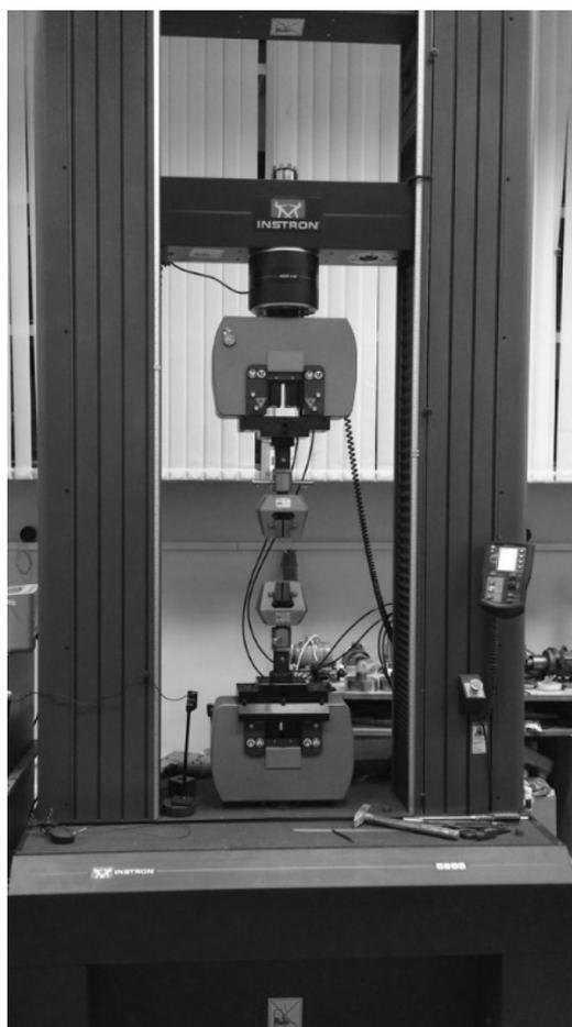
**Рис.1. Испытательная машина INSTRON 5988**
