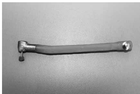
Рис. 2. Устройство для определения степени податливости тканей протезного ложа беззубой нижней челюсти (фото)
