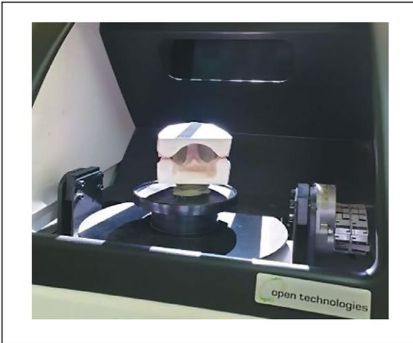
**Рисунок 2.** Сканирование гипсовых моделей.
